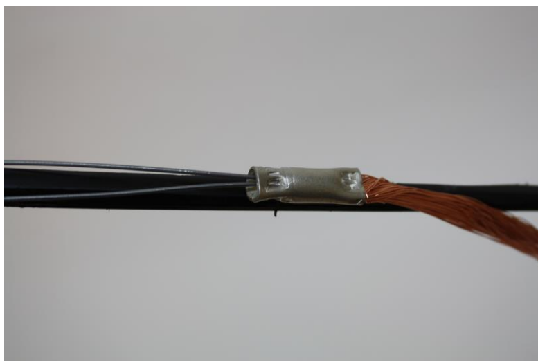
Kaapelin vetolangat kytkettynä 16 mm 2 :n kuparijohtimeen
