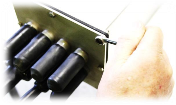
Jatkoslevy tai -levyt ovat nyt lukittuina myös pystysuunnassa.
